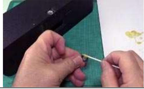
④三脚穴カバーに接着剤を塗り接着する。
