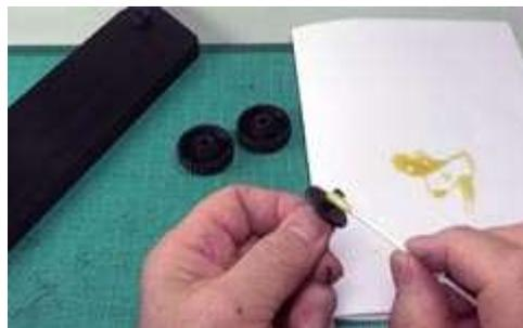
②中軸にボンドを付けて、カメラ上蓋を挟むようにノブと接着する。
