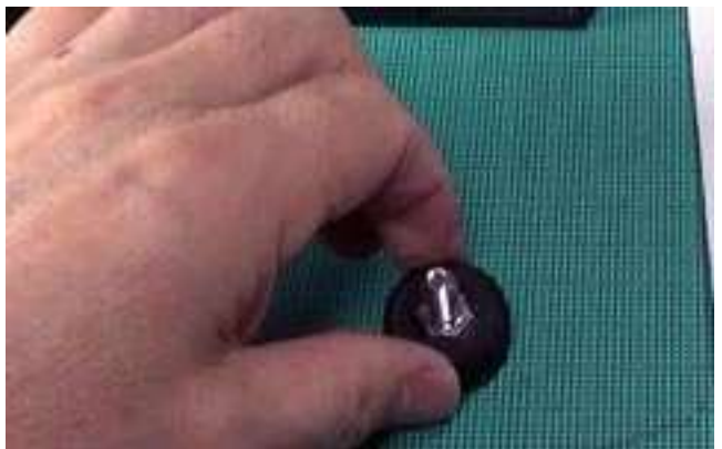
③さらにボルトを接着する。
