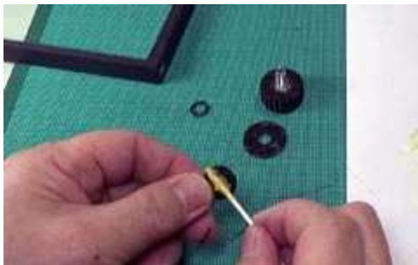
⑩ゴムシートにストッパーを貼り、余分なゴムシートをカットする。
