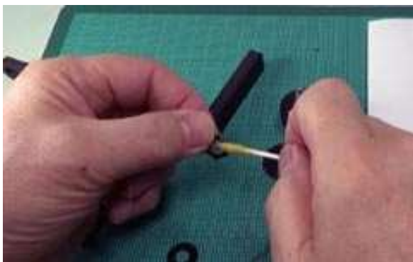
⑨ゴムシートにボンドを塗る。
