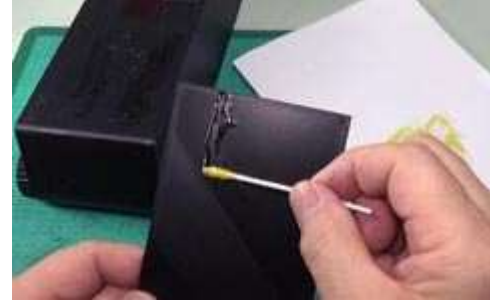
④赤窓カバーにボンドを塗り接着する。
