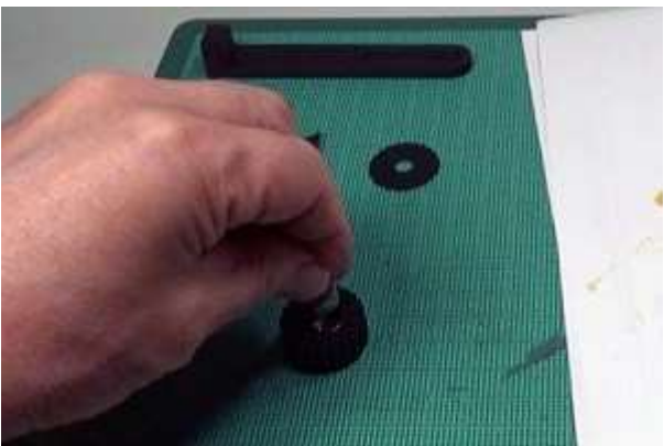
③さらにボルトを接着する。
