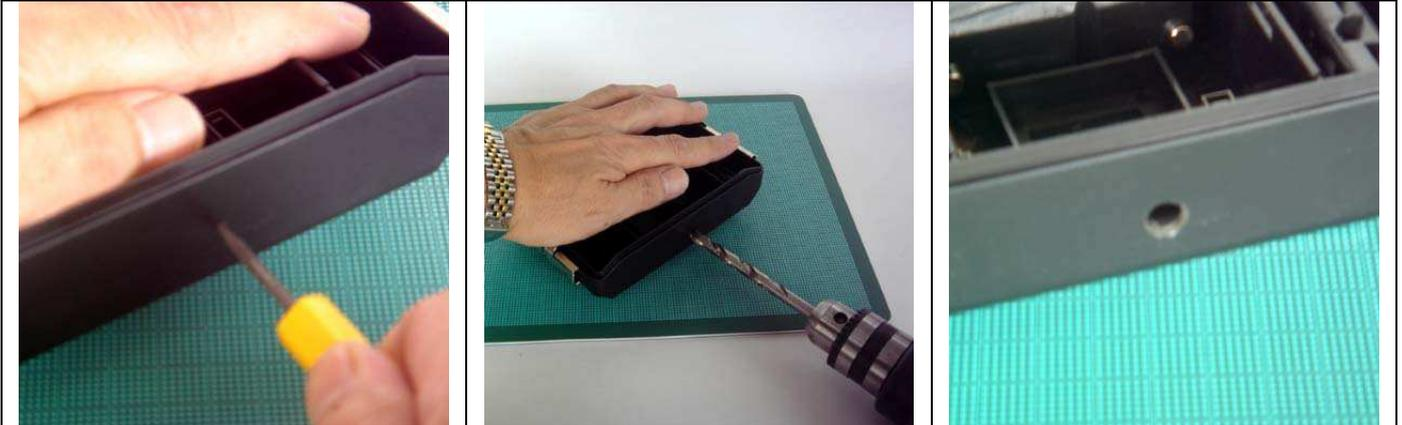
三脚穴を取り付けるところに、下穴をしっかりと付け、ドリル(7mm)で穴を開ける
