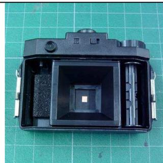
12 枚撮影し終わったら最後まで巻きます。裏蓋を開けフィルムを取り出します。裏紙の端は内側に折り曲げ、フィルムの最後にある「撮影済」のテープで止めます。
