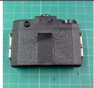
フィルムの裏紙を右側のスプールの溝に差し込み、巻き上げノブを回しながらしっかり巻きます。「START」の文字が出てきたら、裏蓋を閉じます。
