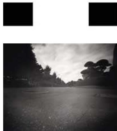
入射角度による光量低下(ピンホール直径:0.24mm、素材厚さ:0.10mm)
