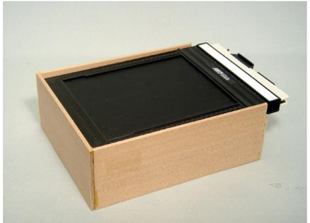
底部の板に内部木枠を圧着し、側面、上部と貼っていきます。フォルダーが入るか確認してください。
