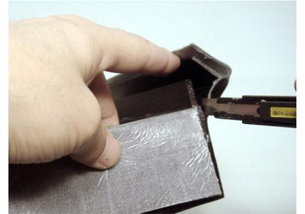
上図のように切れ目を入れ、L字の塩ビに貼り付けます。L字塩ビの内側にカッターを入れ端までカットします。
