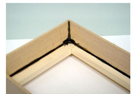
グルーガンで内部木枠の接着部を埋めます。角の部分はグルーをたらし、熱い内に綿棒等で均します。
