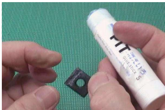
①ピンホール台にノリを付け、ピンホールを貼る。
