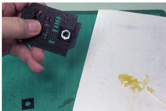
①前面下の三脚穴にボンドを塗り、ビスを入れる。
