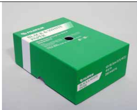
ピンホールを装着する穴を開けます。
