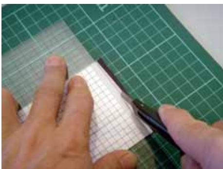
周りに貼る布の端をカッターでカットします
