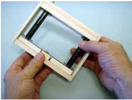
スプール押さえを入れた状態で、スムーズに回るか確認します
