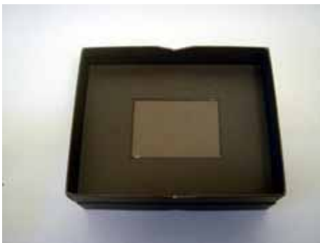
カッターで少しずつ切れ目を入れ、穴を空けます
